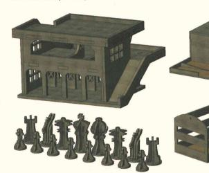
Ci-dessus, les cinq modèles devront être découpés sur une machine laser. Ces différents modèles sont composés au total de 120 pièces. Si l'opérateur utilise les fonctions de base d'ALPHACAM, il devra pour chaque pièce, effectuer l'alignement; en extraire les géométries; appliquer les trajets d'outils et ensuite, effectuer une imbrication de toutes les pièces. Le travail prendra un certain temps et sera particulièrement répétitif.
